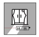
激光测距传感器安装周围应避免强光照射。
