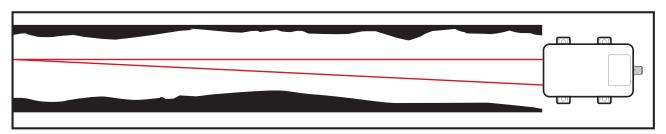
若管道较小,则需将产品安装时应远离管道口,以防接收不到激光。
